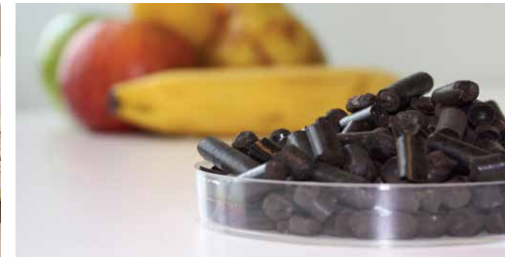
Können in der Industrie und in Privathaushalten zur sauberen Verbrennung genutzt werden: Pellets aus Biokohle, hergestellt durch hydrothermale Karbonisierung.
